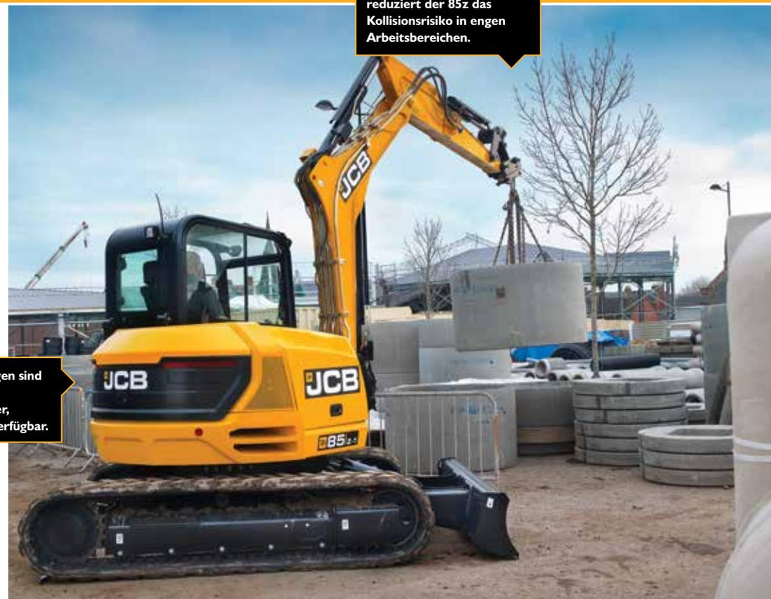
Durch sein echtes Nullheck reduziert der 85z das Kollisionsrisiko in engen Arbeitsbereichen.
