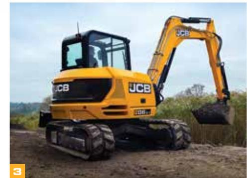
Abdeckungen für die Zylinder am Ausleger und Löffelstiel bieten optimalen Schutz für härteste Einsatzbedingungen und sind optional verfügbar.
