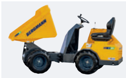
C801e – der kleine Bruder mit einer Breite von 980 mm und einer Nutzlast von 950 kg
